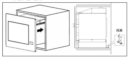
5. 打開爐門,用螺絲B將微波爐固定在櫥櫃上的安裝孔位置。
