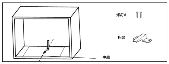
3. 移開安裝模板,並用螺釘A固定托架。
